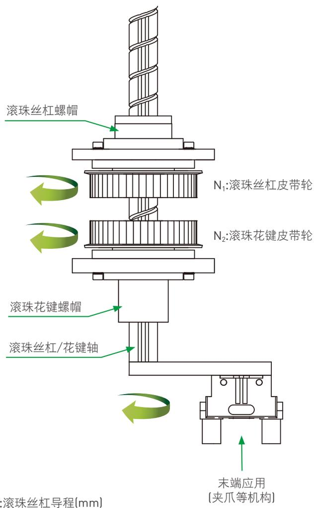
N<sub>1</sub>:滚珠丝杠皮带轮旋转速度(顺时针)(min<sup>-1</sup>)
